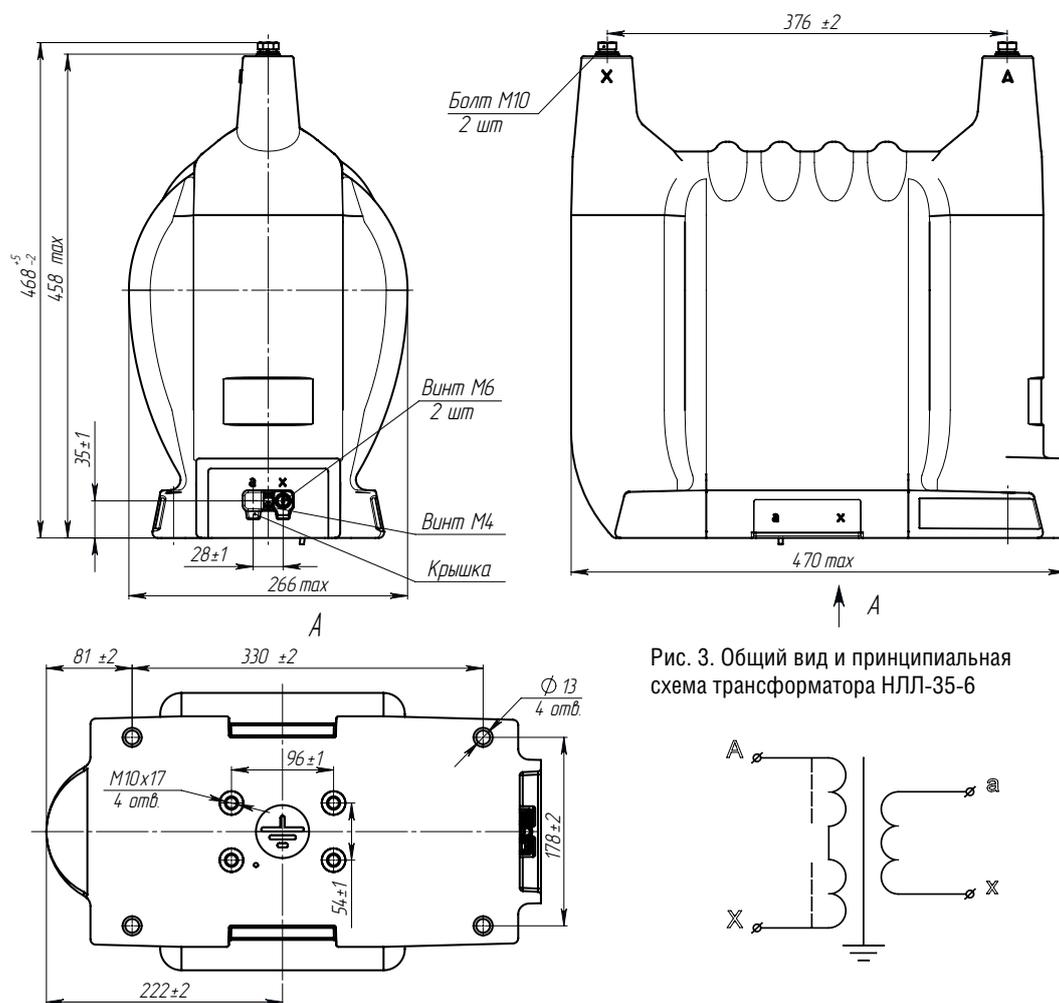
Рис. 3. Общий вид и принципиальная схема трансформатора НЛЛ-35-6
